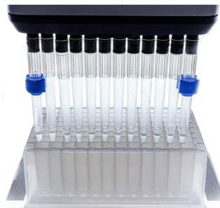
電動ピペットで 12 検体精製
